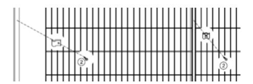
Einzelschellen werden bei Gitteranfang u. Ecken, Doppelschellen bei Mattenstößen angewendet. Wir empfehlen für die Montage nicht direkt an die Keller Seitenwände zu gehen sondern ersten Pfosten entsprechend einzurücken und Gittermatte überstehen zu lassen um Wand nicht zu beschädigen.
